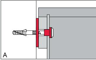
Schrank unten mit Gummunterlagen und Gummitüllen befestigen.
