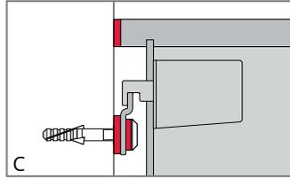
Schrankboden oder Seitenwände mit Gummiband entkoppeln.
