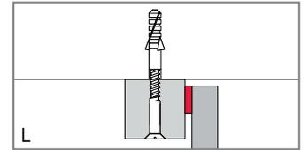
Blenden stirnseitig mit PE-Band von Wand entkoppeln.
