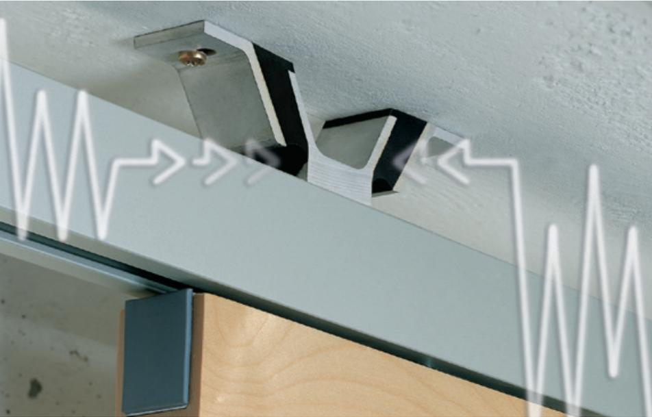
Schiebetüren können je nach Bausituation Schwingungen auf das Gebäude übertragen. Damit macht nun HAWA-SoundEx ein- für allemal Schluss. Diese Schallschutzbügel werden schnell und einfach an der Decke angebracht. Anschliessend wird die Laufschiene durch die Originalbohrungen mittels Nutensteinen an die Bügel geklemmt. Und schon herrscht Ruhe in den angrenzenden Räumen.
