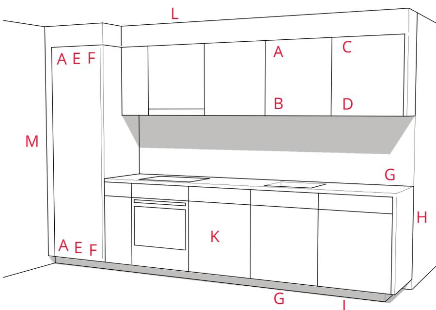
Die Stauffer Dämmkomponenten für Küchen erfüllen bei korrektem Einbau die erhöhten Anforderungen der SIA-Norm 181:2006. Bei der Prüfung wurde das Resultat an einer einschaligen Beton-Wohnungstrennwand von 25 cm erreicht. Bei einer zweischaligen Wohnungstrennwand werden noch bessere Dämmwerte erzielt.
