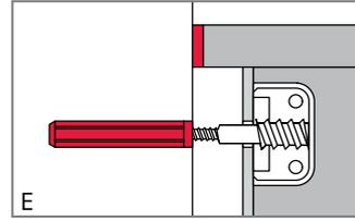
Hochschrank mit Distanzschraube und Gummidübel befestigen und mit Gummiband von Wand entkoppeln.
